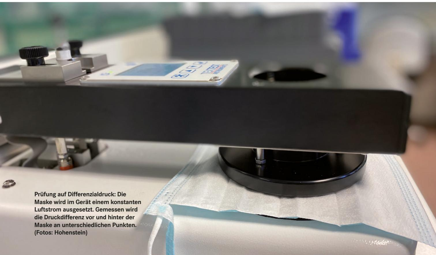
Prüfung auf Differenzialdruck: Die Maske wird im Gerät einem konstanten Luftstrom ausgesetzt. Gemessen wird die Druckdifferenz vor und hinter der Maske an unterschiedlichen Punkten. (Fotos: Hohenstein)
