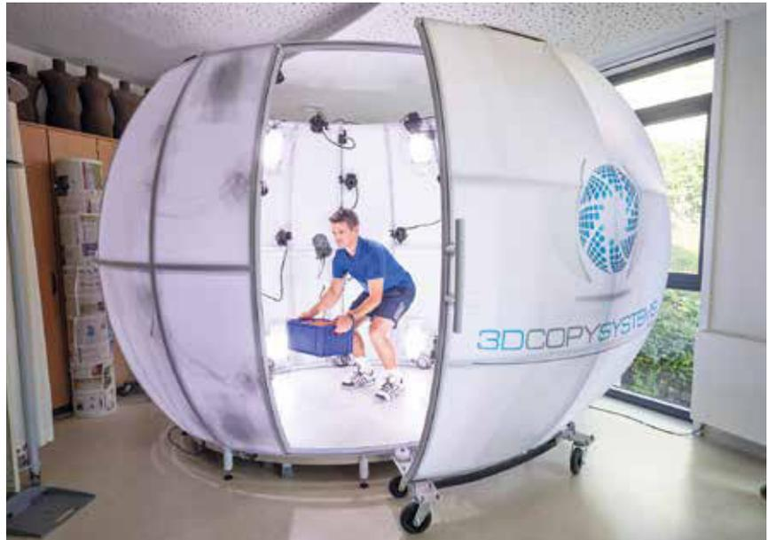
Mit Hilfe eines 4D-Scanners ist Hohenstein in der Lage, nicht nur die Körpermaße zu erfassen, sondern auch die Veränderung von Körpermaßen während der Bewegung. Dadurch ist es insbesondere bei Sport- und Berufsbekleidung möglich, den Bewegungsumfang im Hinblick auf eine verbesserte Funktion zu analysieren.
