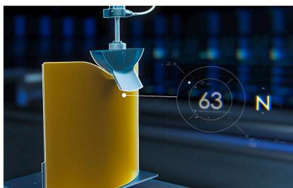
*Der Edge Pressure (EP)-Test bildet die Form des Arms und die Krümmung einer ballistischen Weste nach und quantifiziert das Unbehagen, das an lokalen Druckpunkten entsteht. Bild: Mit freundlicher Genehmigung von DuPont ©2024*
