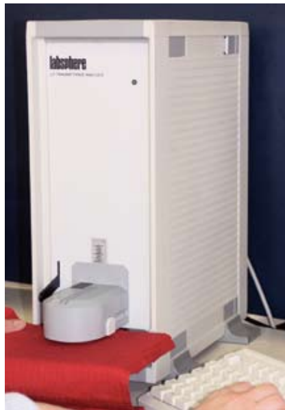
Mit diesem Gerät kann mittels Transmissionsmessungen der UV-Schutz von Textilien aber auch von Sonnenschutzcremes ermittelt werden.
